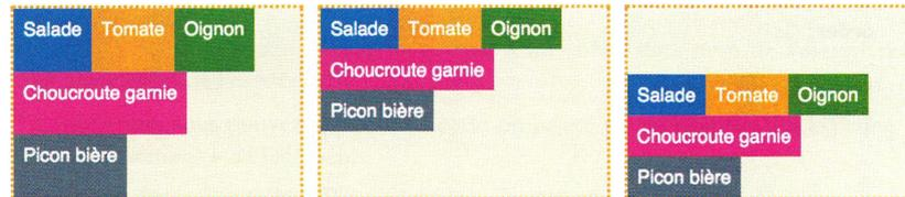
Figure 2-23 Les valeurs stretch, flex-start et flex-end au sein d'un parent en flex-direction: row
