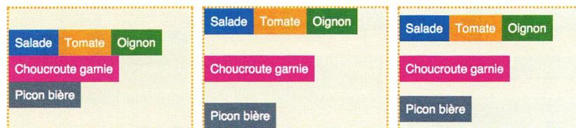
Figure 2-24 Les valeurs center, space-between et space-around au sein d'un parent en flex-direction: row
